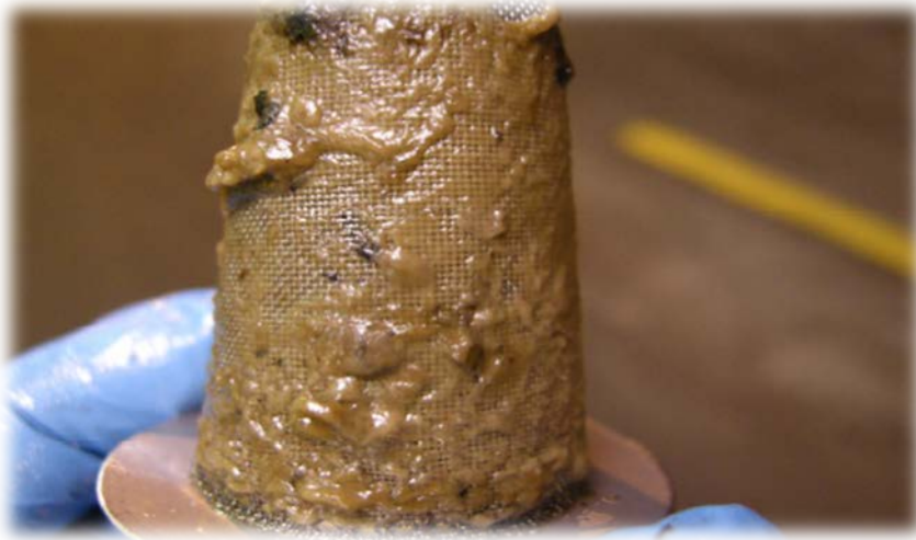
Filtro “cappello di strega” dei serbatoi
