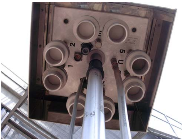
Figura 5. Portafiltri con filtri in campionamento.
