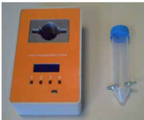
Figura - Il sistema portatile per la misura dell'acidità libera in olio di oliva e la provetta modificata con elettrodi per la caratterizzazione dei parametri elettrici dell'emulsione.
